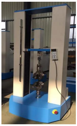
图 10 摆动/扭曲试验设备
